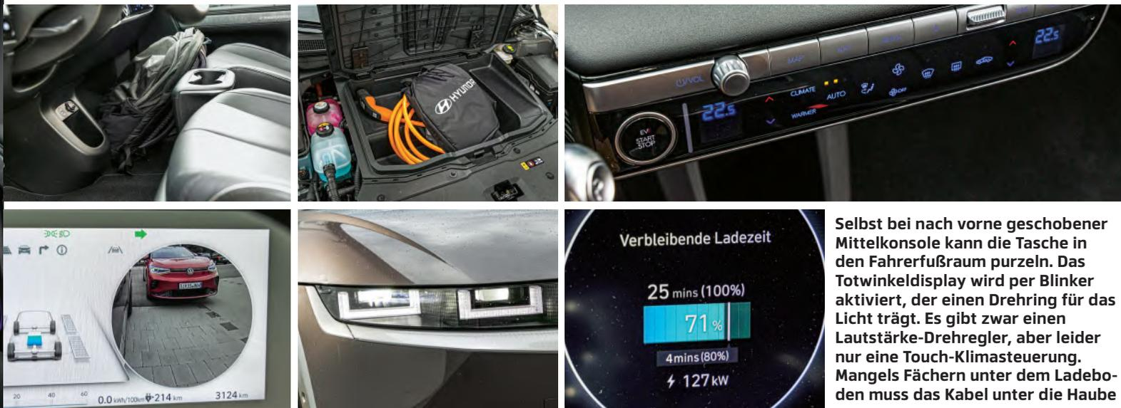
Selbst bei nach vorne geschobener Mittelkonsole kann die Tasche in den Fahrerfußraum purzeln. Das Totwinkeldisplay wird per Blinker aktiviert, der einen Drehring für das Licht trägt. Es gibt zwar einen Lautstärke-Drehregler, aber leider nur eine Touch-Klimasteuerung. Mangels Fächern unter dem Ladeboden muss das Kabel unter die Haube
